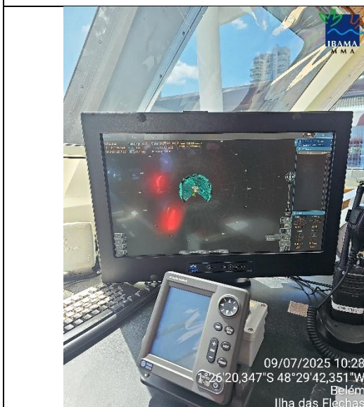
Item 14 - Radar de óleo Miror com câmera FLIR
