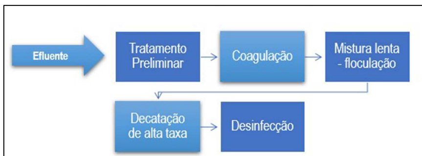
Figura 2: Fluxograma do tratamento na CSAO.
