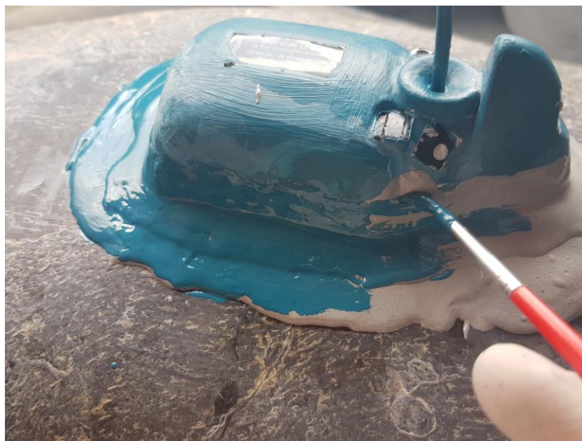
Pintura do PTT após a fixação
