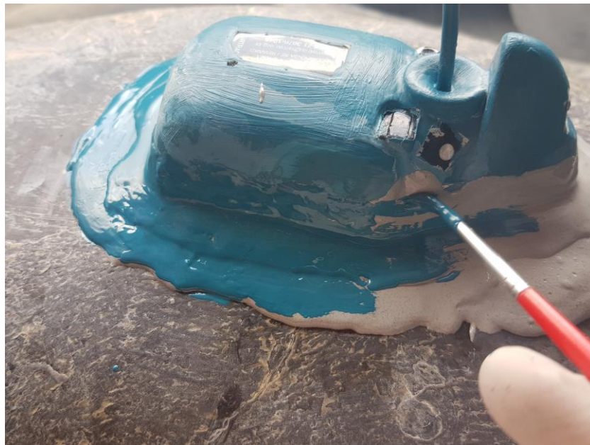
Pintura do PTT após a fixação
