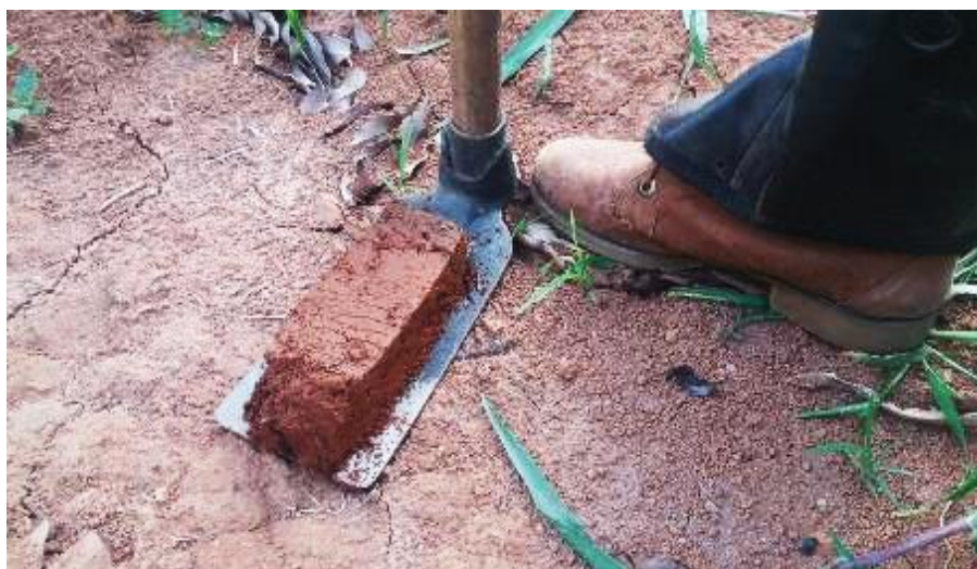
Figura 10 - Introdução do enxadão na parede da mini trincheira e amostra coletada após o descarte do solo das extremidades do enxadão
