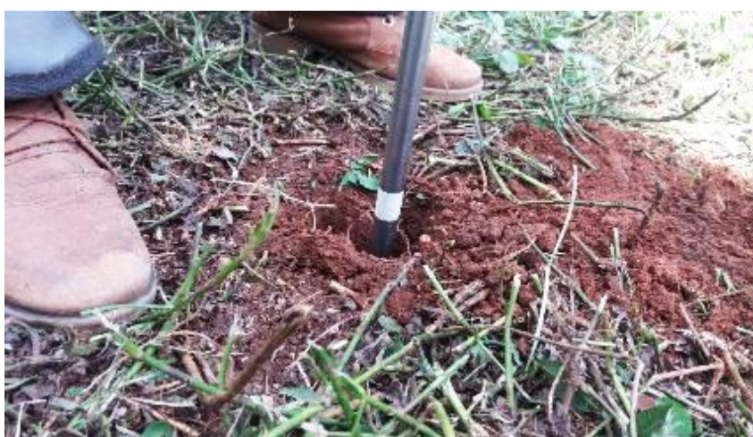
Figura 8 - Limpeza da superfície de coleta e introdução do trado até a marcação do limite de profundidade
