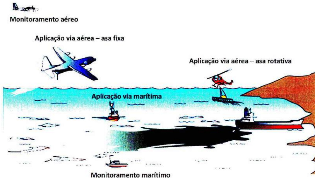
Figura 27: Alternativas para aplicação de dispersantes e monitoramento das operações (Fonte: Adaptado de Spill Tactics for Alaska Responders , 2014).
