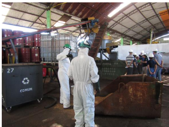
Fig.7 - Galpão 3 – Setor de blendagem – Serragem (concha à direita) e óleo (tanque reservatório branco à esquerda) para blendagem de um material qualquer
