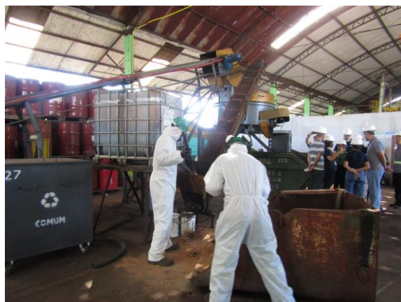
Fig.8 - Galpão 3 – Setor de blendagem – adição manual de insumos ao resíduo a ser tratado
