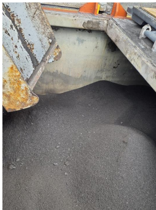
Fig. 10 - Entrada do cascalho no cutting box
