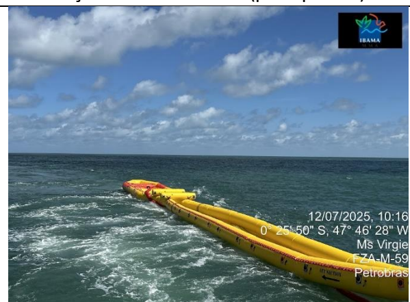
Barreira sendo lançada
