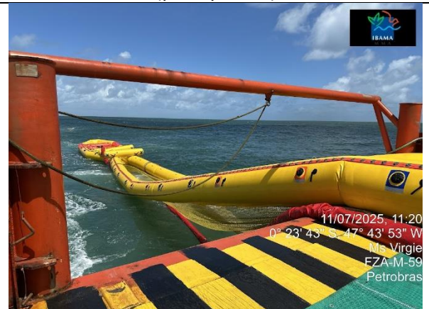
Item 15 - Barreira sendo lançada
