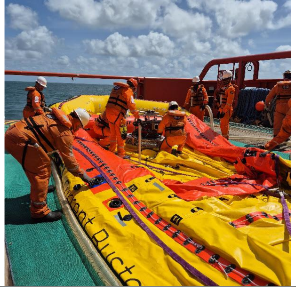
Item 15 - Inflagem da barreira e montagem do recolhedor
