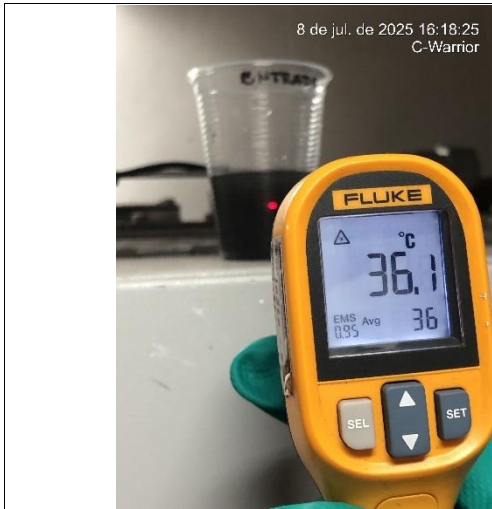
Item 8 – ETE: Medição temperatura amostra de entrada
