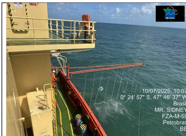
Item 15 - Teste braço lançador de dispersantes bombordo
