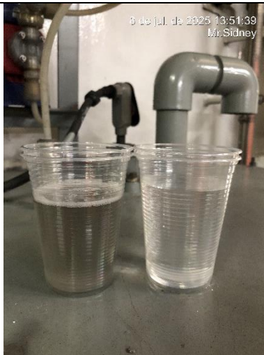
Item 8 – ETE : Comparação das amostras de entrada e saída
