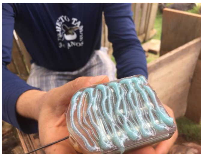
Aplicação do adesivo acrílico na parte inferior do transmissor
