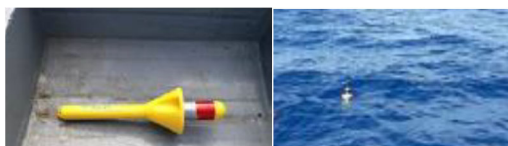
Figura 31: Imagens do modelo de derivador superficial (NOMAD) lançado e considerado na análise comparativa. A direita o equipamento na água após o lançamento. Fonte: ROLLNIC et al , 2020.
