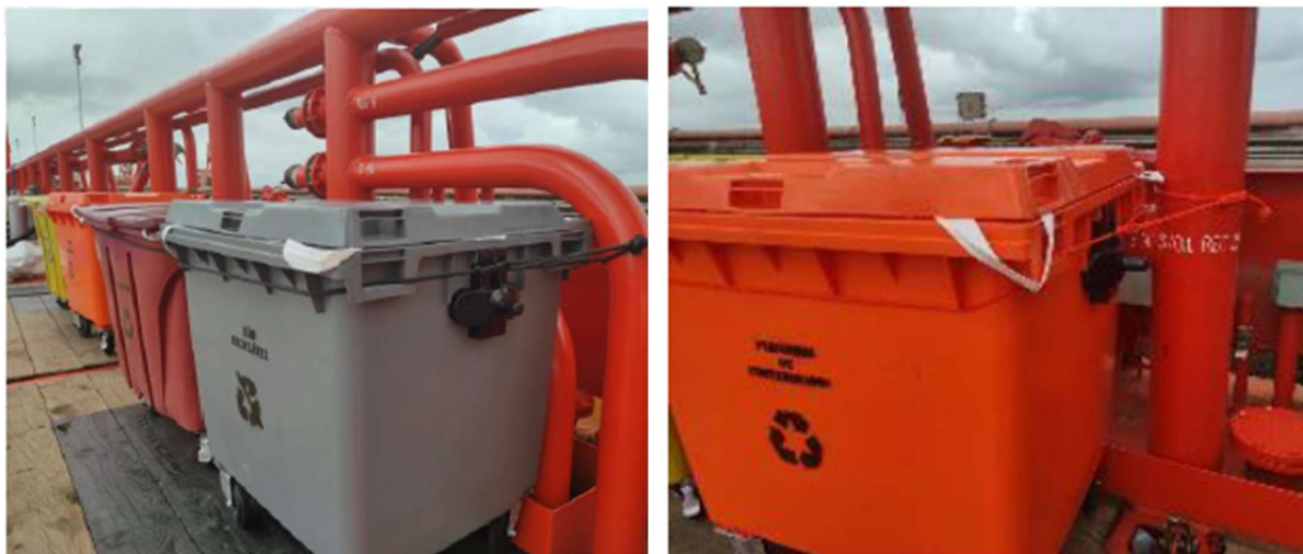
Figura 2: Evidência da amarração dos coletores no deck.
