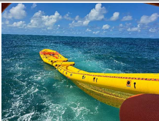
Foto 26: Lançamento da barreira no mar
