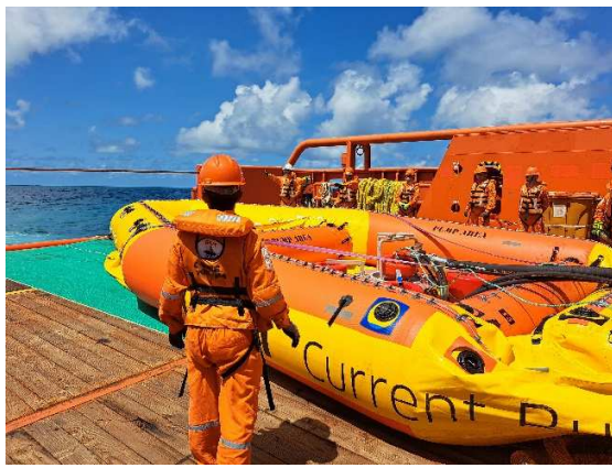
Foto 22: Situação inicial da barreira (pump area pré-inflada)
