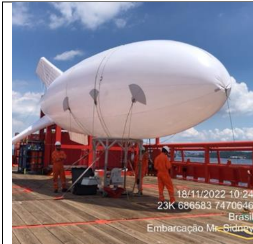
Foto 07: Aeróstato inflado com gás hélio
