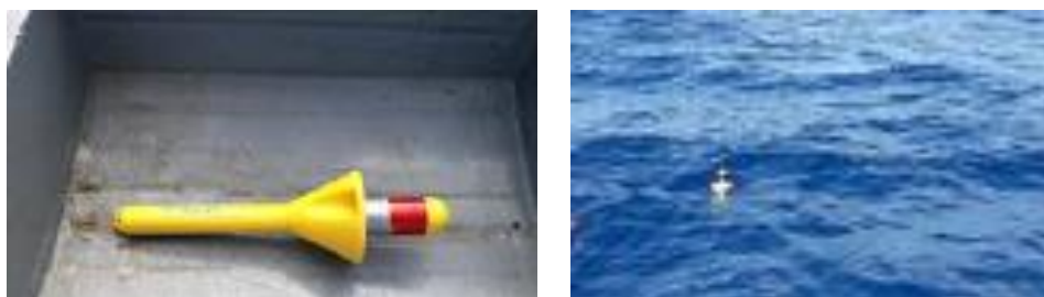
Figura IV.4.1-3 – Imagens do modelo de derivador superficial (NOMAD) lançado e considerado na análise comparativa. A direita o equipamento na água após o lançamento. Fonte: ROLLNIC et al, 2020.
