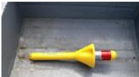
Figura 28: Imagens do modelo de derivador superficial (NOMAD) lançado e considerado na análise comparativa. A direita o equipamento na água após o lançamento. Fonte: ROLLNIC et al , 2020.
