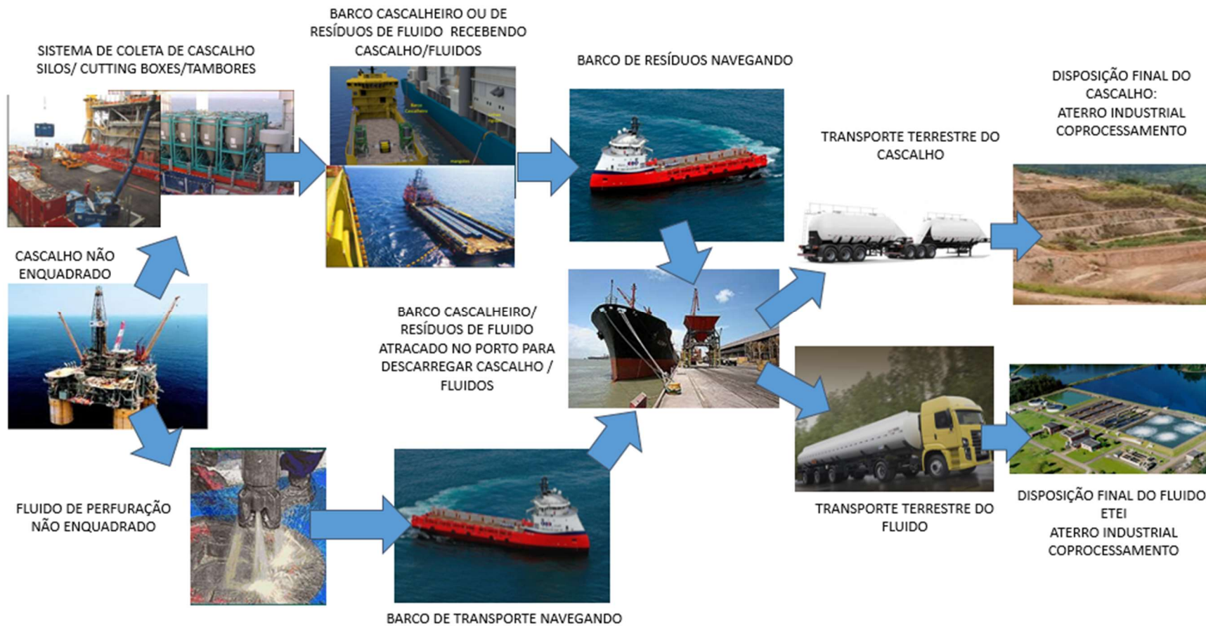
Figura 1 - Recursos para o gerenciamento de resíduos de fluidos e cascalhos.
