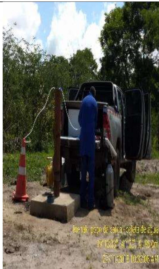
Figura 20 - Coleta de amostra para análise completa de potabilidade no novo poço da Barca
