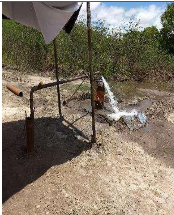
Figura 19 - teste de vazão no novo poço da Barca
