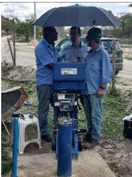
Figura 3- Poço da FUNAI - Perfilagem óptica
