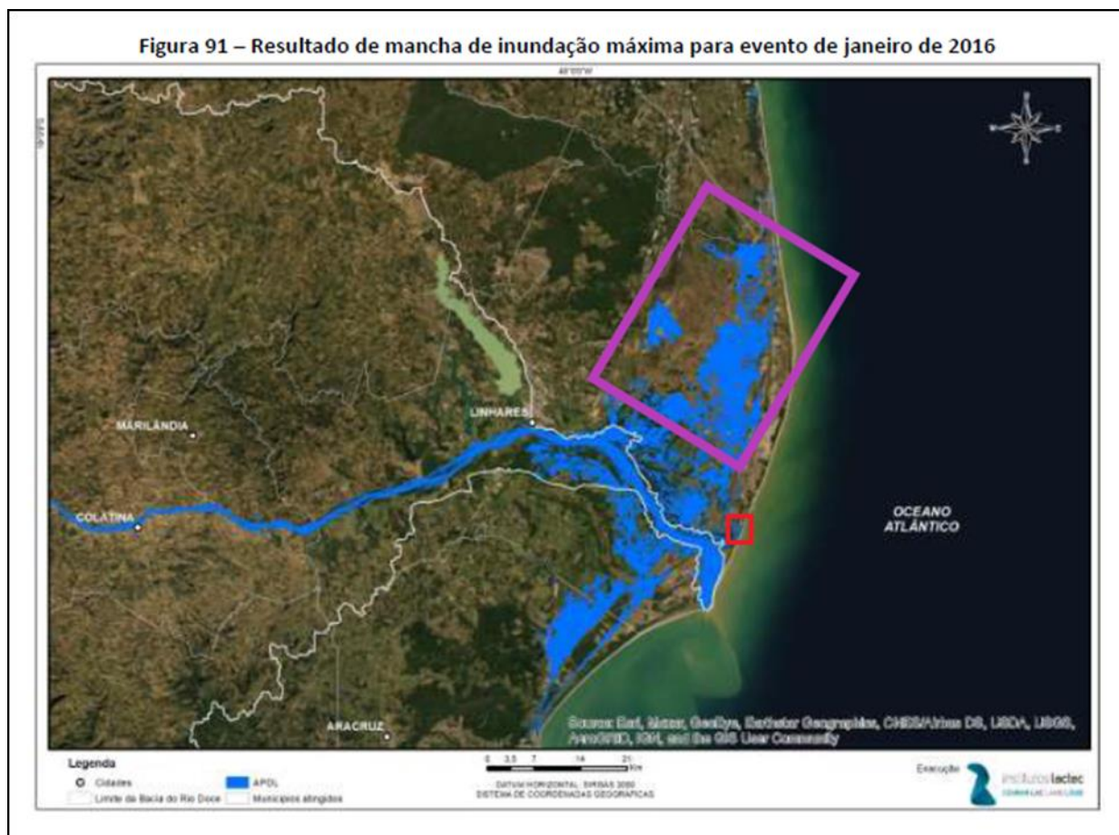
Figura 3-4 - Figura 91 do parecer da Latec, 2020 - Apresenta o resultado da mancha de inundação máxima para o evento de janeiro de 2016. Retângulo vermelho destaca a área da lagoa Monsarás e Retângulo roxo destaca a área de inundação, que corresponde à sub-bacia hidrográfica rio Barra Seca/rio Mucuri.
