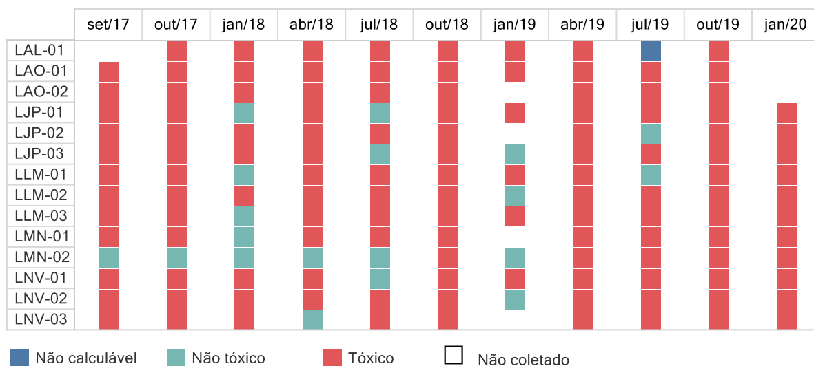
Figura 5-9 Resultados da toxicidade dos ensaios crônicos para Ceriodaphnia dubia no elutriato de sedimento, comparativos entre os meses de amostragem, em pontos amostrais localizados nas lagoas. *Em janeiro/20 não foi possível realizar a coleta na Lagoa Areão (impossibilidade de acesso).
