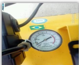
Conferindo a despressurização do compressor
