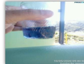
Sistema regenerado sem apresentar dureza
