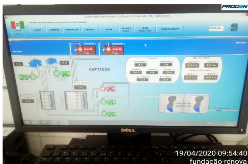
Figura 1 – Painel de monitoramento das bombas e vazão
