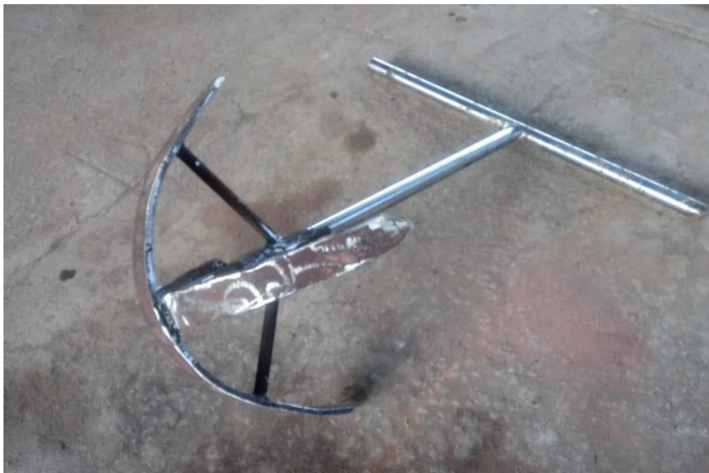
Figura 5- Ancora usada na fixação da boia no fundo do rio.
