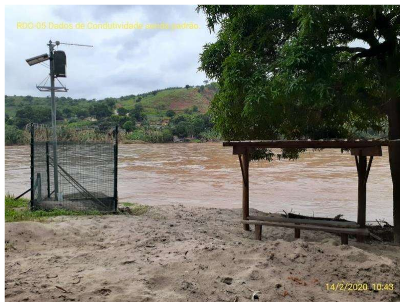
Figura 18 - Caixa de acesso a sonda da RDO 05 encoberta pelo rio.
