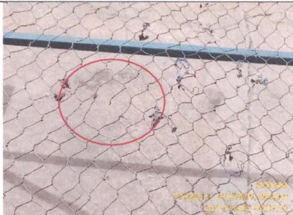
35. Detalhe furo na malha da peneira (02/10/19)
