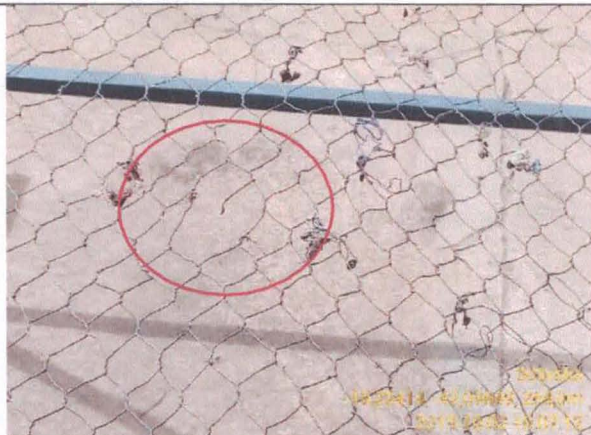
35. Detalhe furo na malha da peneira (02/10/19)
