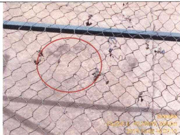
35. Detalhe furo na malha da peneira (02/10/19)
