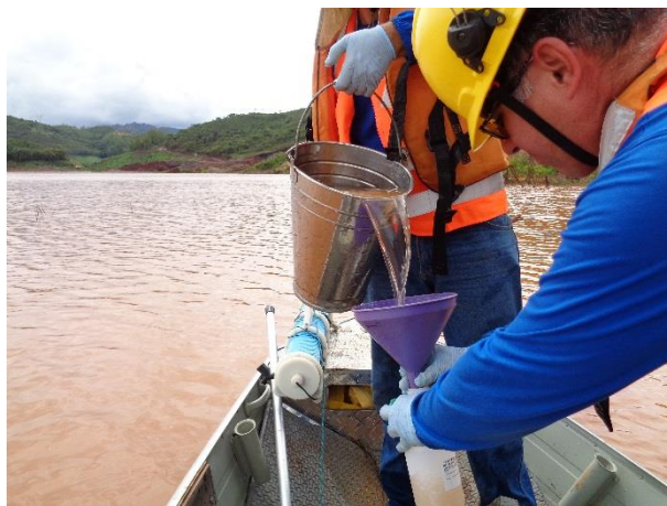
Figura 10: Enchimento de recipientes com amostra coletada em profundidade para análise de água bruta.
