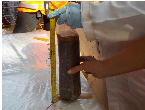
Figura 84: Medição de comprimento e preparação de testemunho recuperado de sedimento, para posterior sectionamento.
