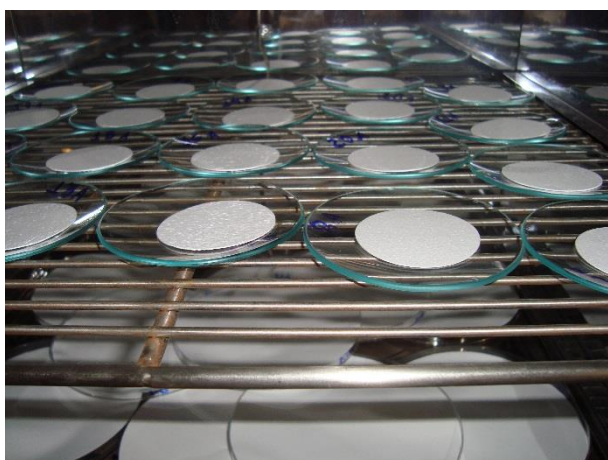
Figura 17: Disposição de membranas de filtração em estufa (membranas mistas de ésteres de celulose com diâmetro de poro de 0.45 \mu\text{m} , e de 0.22 \mu\text{m} ).
