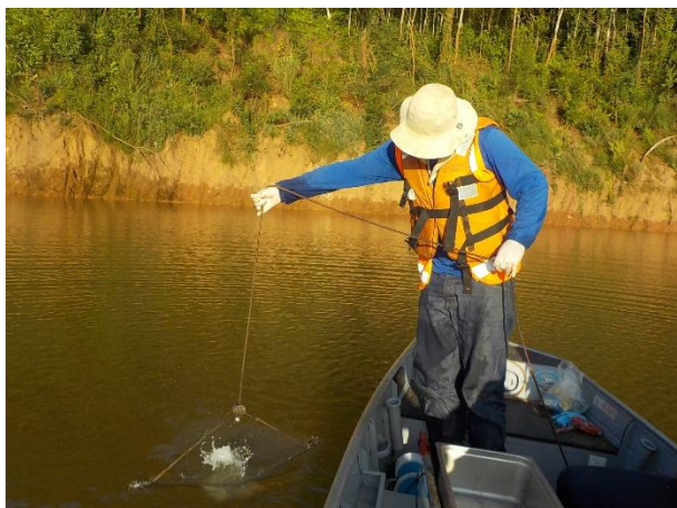
Figura 79: Lançamento de draga Van Veen para coleta de sedimento de superfície.
