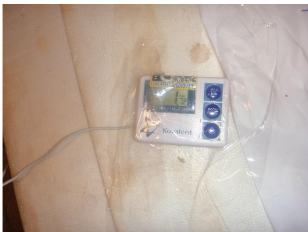
Figura 105: Termômetro para controle de temperatura das amostras de água acondicionadas.
