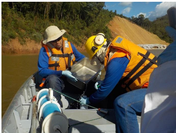
Figura 77: Enchimento de recipiente com amostra coletada em profundidade, para análise de água bruta.
