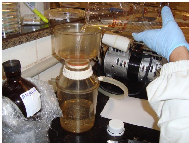
Figura 36: Filtração de amostra de água bruta sobre membrana de fibra de vidro (0,45 µm).
