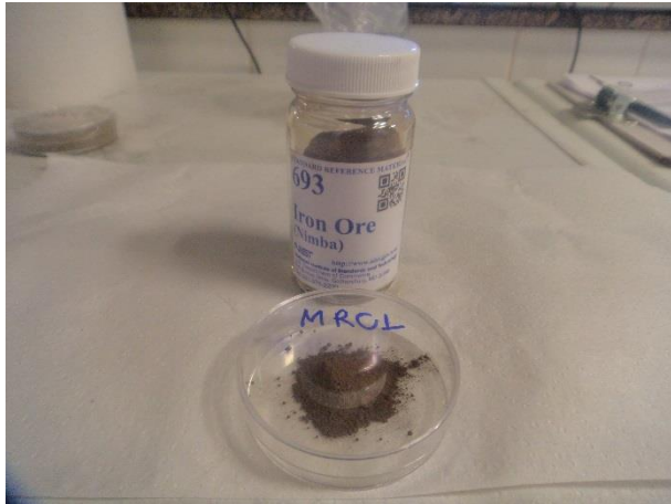
Figura 113: Acondicionamento da amostra de material de referência certificado (minério de ferro) para fins de controle de qualidade / garantia de qualidade.
