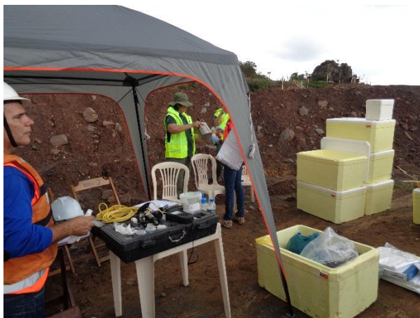
Figura 15: Vista panorâmica: sonda multiparâmetro para medição dos parâmetros de campo, e caixas para preservação de amostras
