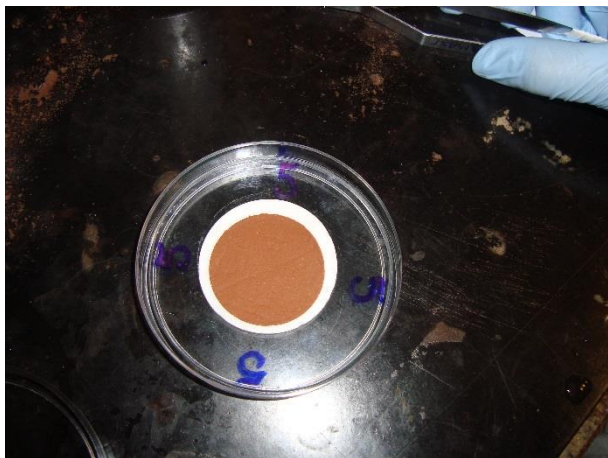
Figura 37: Aspecto da membrana de fibra de vidro (0,45 µm) colmatada e acondicionada em Placa de Petri, para posterior secagem.
