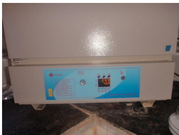
Figura 88: Estufa utilizada para a secagem prévia das membranas filtrantes (secagem a 40 °C).
