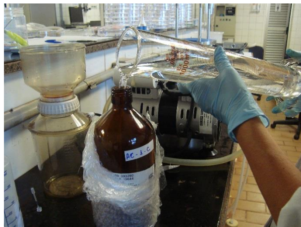
Figura 46: Transferência da amostra filtrada nas membranas de 0,22 \mu\text{m} , para envio ao laboratório e posterior análise.
