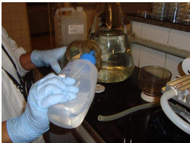
Figura 39: Procedimento de limpeza do equipamento de filtragem utilizado para as membranas de fibra de vidro.
