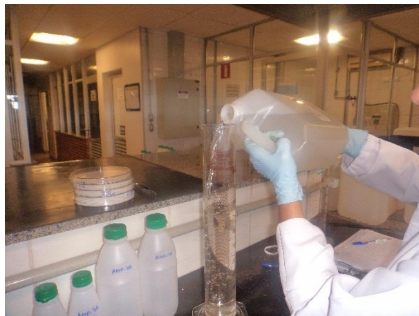
Figura 90: Transferência de amostra de água bruta para proveta, para determinação do volume a ser filtrado.
