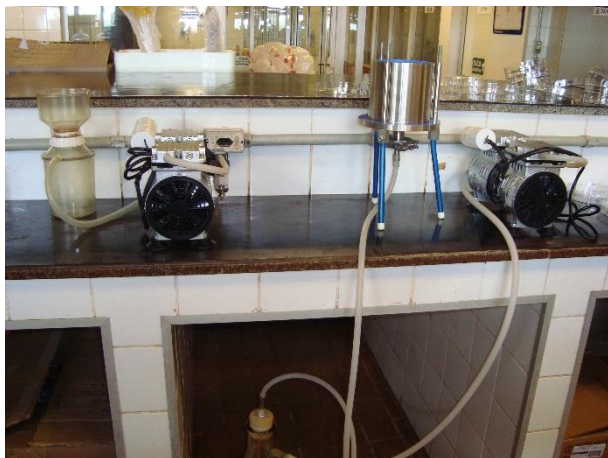
Figura 19: Sistemas de filtração utilizados no programa.
