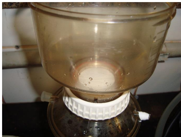
Figura 40: Sistema de filtração montado, contendo membrana de fibra de vidro (0,22 µm).
