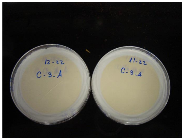
Figura 48: Membranas mistas de ésteres de celulose de 0,22 \mu\text{m} , após filtração, secagem e pesagem.
