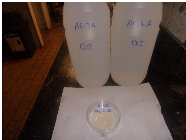
Figura 102: Conjunto de membranas de ésteres de celulose (0,22 \mu\text{m} ) e fracos contendo filtrados correspondentes (materiais de um mesmo ponto de amostragem).
