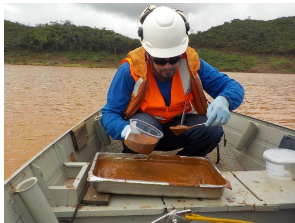
Figura 14: Transferência da amostra de sedimento de superfície da bandeja de inox para recipientes de plástico.
