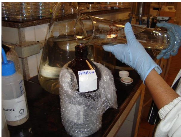
Figura 45: Transferência da amostra filtrada nas membranas de 0,45 \mu\text{m} , para envio ao laboratório e posterior análise.
