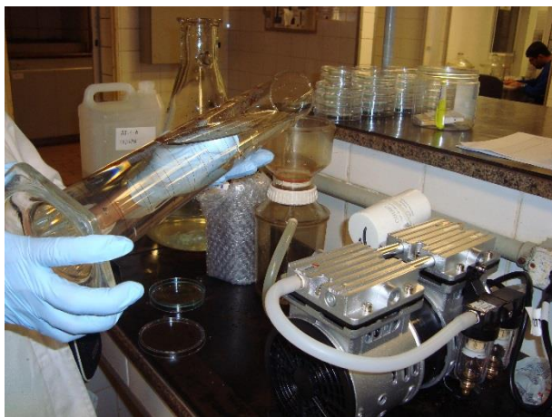
Figura 41: Filtragem de amostra, filtrada em 0,45 µm, sobre membrana filtrante se 0,22 µm (membranas de fibra de vidro).
