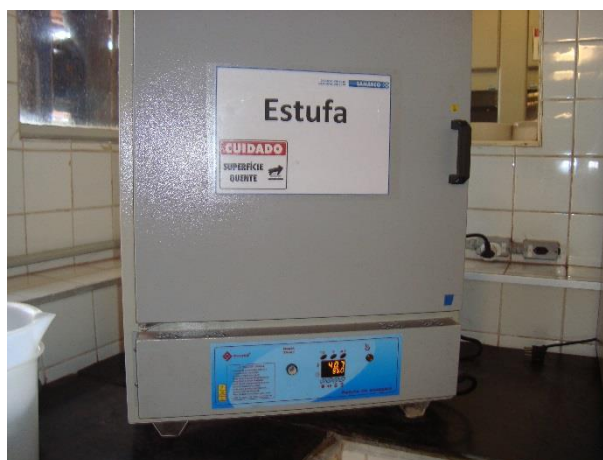
Figura 18: Estufa utilizada para a secagem prévia das membranas filtrantes (secagem a 40 \text{ }^\circ\text{C} ).
