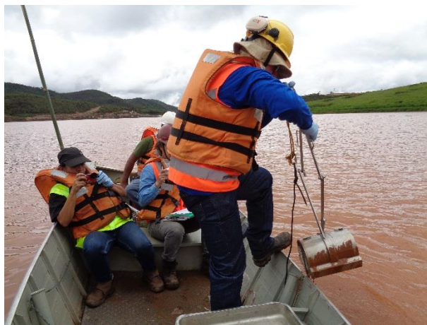
Figura 12: Içamento da draga Van Veen com amostra de sedimento de superfície.
