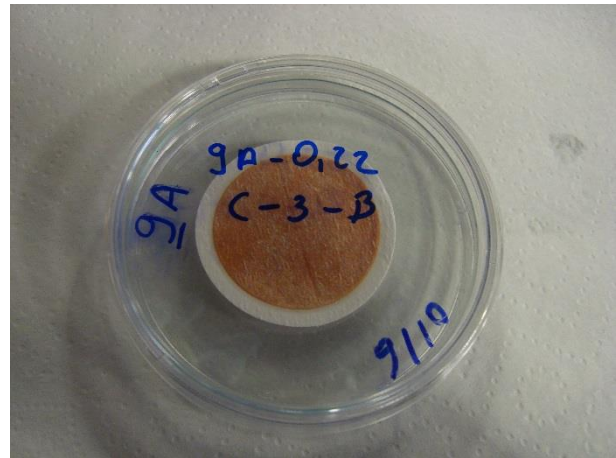
Figura 50: Membrana de fibra de vidro de 0,22 \mu\text{m} , após filtração, secagem e pesagem.
