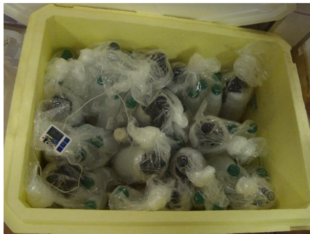
Figura 62: Amostras acondicionadas em cooler de água filtrada em membranas de 0,45 \mu\text{m} e de 0,22 \mu\text{m} . Presença de termômetro para controle de temperatura das amostras.
