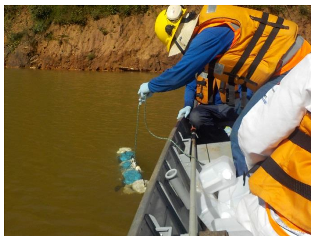
Figura 76: Coleta de amostra de água bruta em profundidade, com suporte de Garrafa van Dorn.
