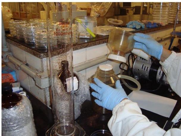
Figura 35: Colocação de membrana de fibra de vidro com diâmetro de poro de 0,45 µm, no sistema de filtração.
