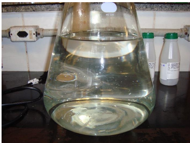
Figura 27: Aspecto de uma porção água bruta, filtrada em membrana filtrante de 0.45 \mu\text{m} .
