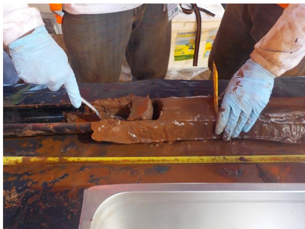
Figura 69: Amostragem de sedimento segundo a seção definida.
