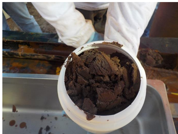
Figura 70: Preenchimento de recipiente com amostra de sedimento.
