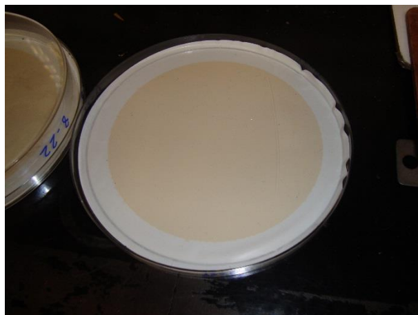
Figura 34: Aspecto da membrana filtrante de 0,22 µm colmatada, e acondicionada em Placa de Petri para posterior secagem.
