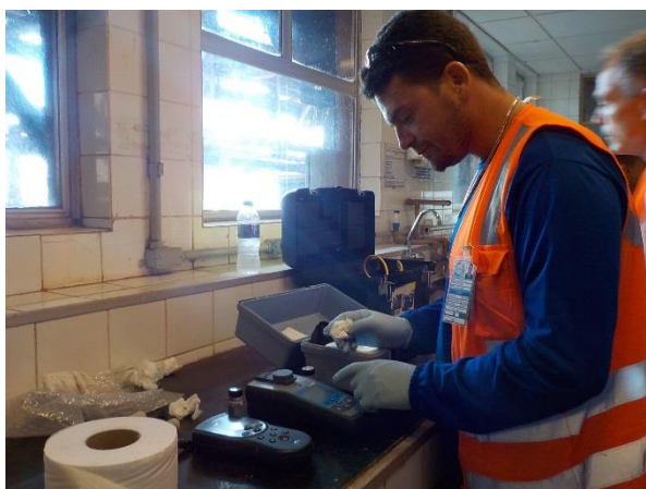
Figura 63: Procedimento de verificação da calibração dos equipamentos utilizados na medição de parâmetros de campo.
