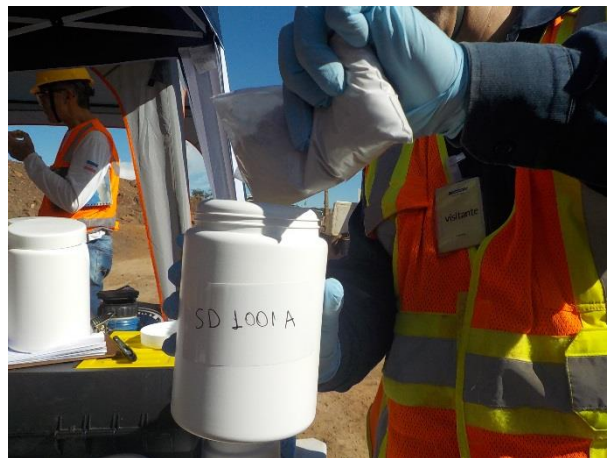
Figura 72: Preparação, em campo, de amostra de areia quartzosa certificada para fins de controle de qualidade / garantia de qualidade.
