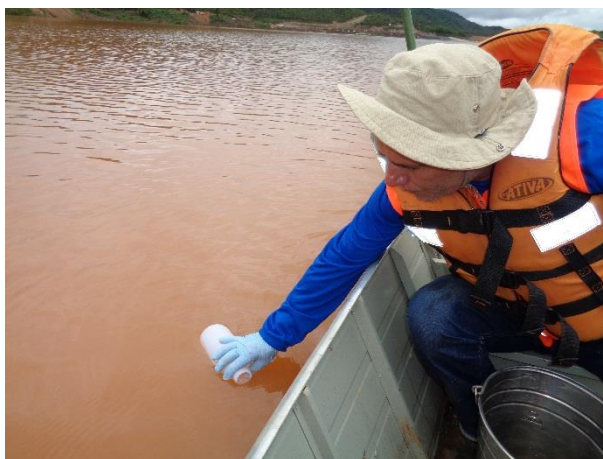
Figura 6: Coleta de água bruta da superfície da coluna d'água para análise.
