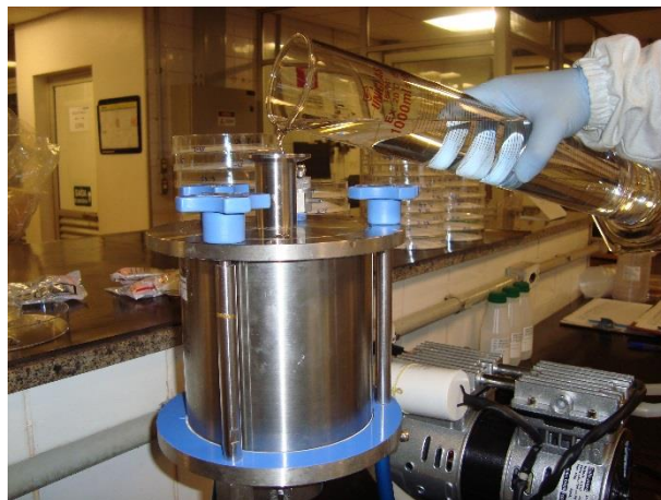
Figura 32: Filtração de amostra (já filtrada em 0,45 µm) sobre membrana filtrante de 0,22 µm.
