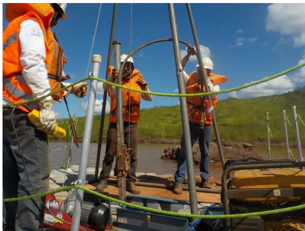
Figura 66: Procedimento de amostragem de sedimento em perfil (testemunhador vibracore).
