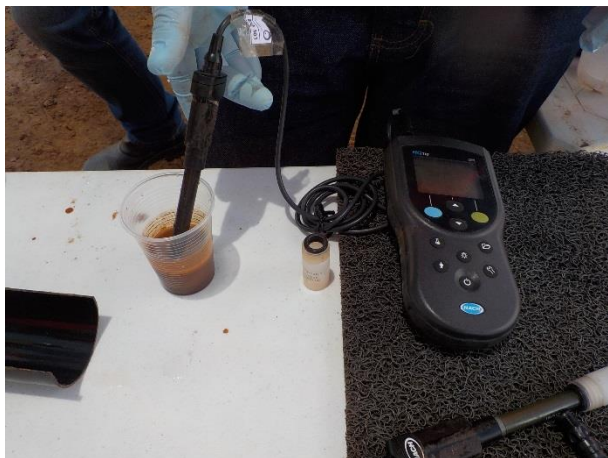
Figura 71: Medição de parâmetros de campo em amostra de sedimento.
