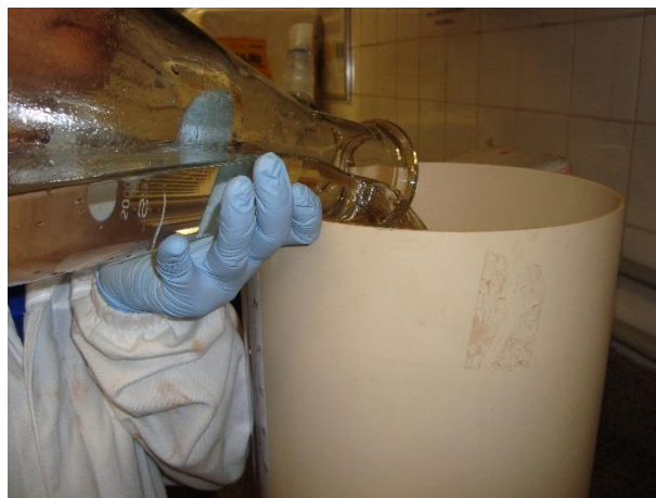
Figura 28: Transferência de amostra filtrada para determinação do volume a ser filtrado na membrana de ésteres de celulose, com diâmetro de poro de 0,22 \mu\text{m} .
