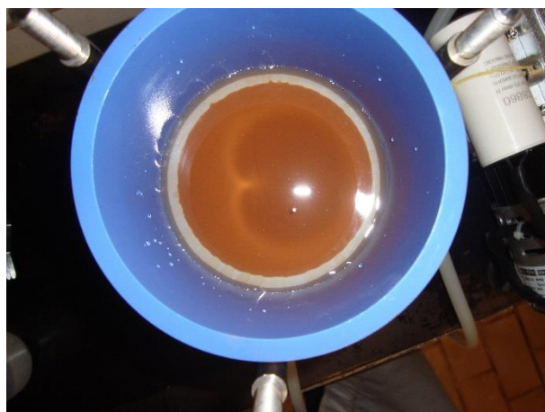
Figura 24: Vista superior do equipamento de filtração mostrando membrana filtrante ( 0.45 \mu\text{m} ) coberta com sólidos, após filtração de amostra de água bruta.
