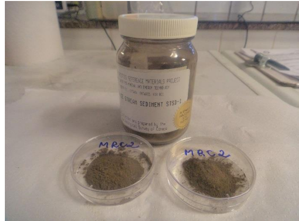
Figura 114: Acondicionamento da amostra de material de referência certificado (sedimento) para fins de controle de qualidade / garantia de qualidade.
