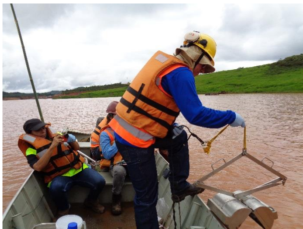
Figura 11: Lançamento da draga Van Veen para coleta de sedimento de superfície.
