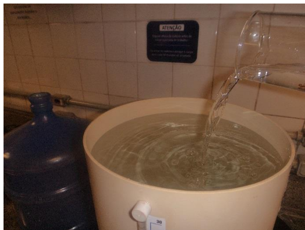
Figura 92: Transferência de amostra filtrada para determinação do volume a ser filtrado em membrana mista de ésteres de celulose de 0,22 µm.
