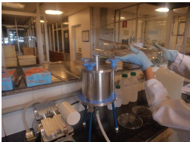
Figura 91: Filtração de amostra de água bruta (membrana filtrante de 0.45 µm).
