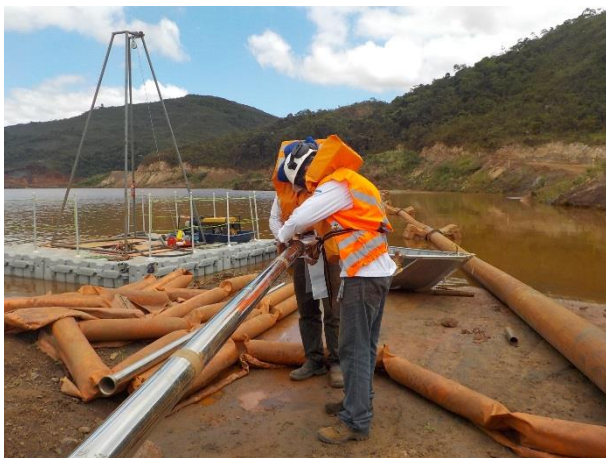
Figura 65: Preparação do testemunhador para coleta de sedimentos em perfil.
