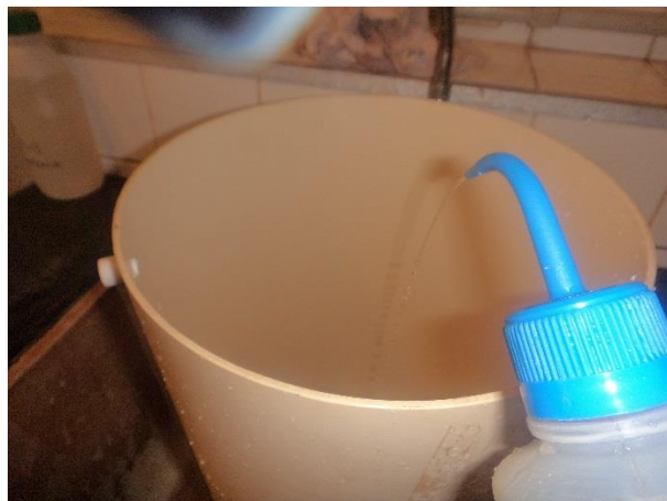
Figura 96: Limpeza do recipiente para medição do volume das amostras filtradas.
