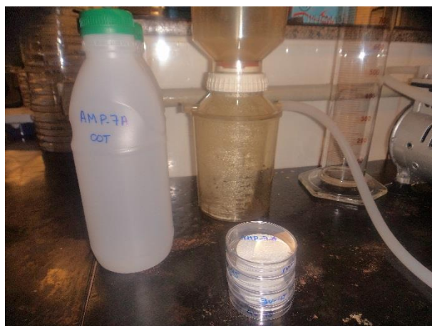
Figura 100: Conjunto de membranas de fibra de vidro e amostra de água preparadas para análise de parâmetros orgânicos (materiais de um único ponto de amostragem).
