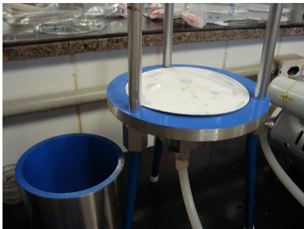
Figura 31: Membrana filtrante (0,22 µm) sobre a plataforma de filtros do sistema de filtração.
