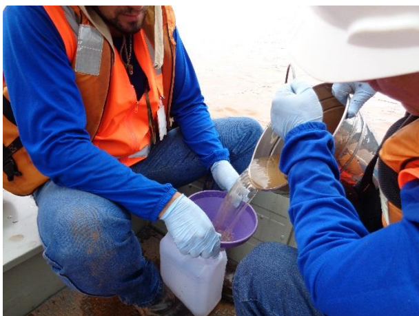
Figura 5: Enchimento de recipiente com amostra de água bruta para posterior filtração.
