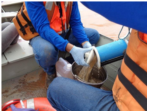
Figura 8: Transferência da amostra de água bruta da Garrafa van Dorn para o balde de inox.
