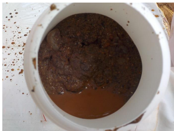
Figura 86: Amostra de testemunho de sedimento coletada no rio do Carmo.
