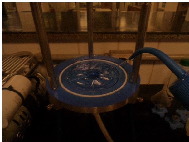
Figura 98: Procedimento de limpeza do suporte de filtro do sistema de filtração.
