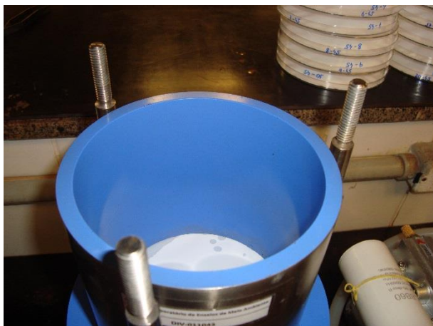
Figura 21: Suporte do equipamento de filtração acoplado à plataforma contendo membrana filtrante ( 0.45 \mu\text{m} ).
