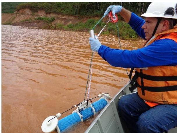
Figura 7: Coleta de amostra de água bruta com auxílio de uma Garrafa van Dorn.
