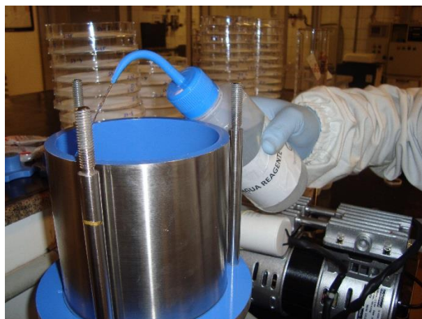
Figura 30: Procedimento de limpeza do equipamento de filtração.
