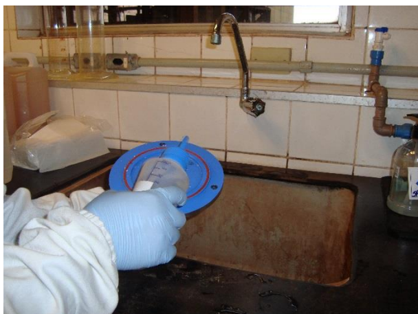
Figura 29: Procedimento de limpeza da plataforma de suporte de filtro, do sistema de filtração.
