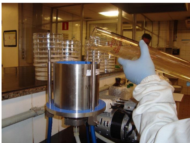
Figura 23: Filtração de amostra de água bruta (membrana filtrante de 0.45 \mu\text{m} ).
