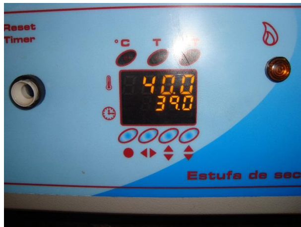
Figura 44: Secagem das membranas na estufa à temperatura 40 °C, para posterior pesagem.
