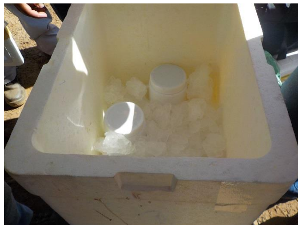
Figura 74: Acondicionamento de amostras de sedimentos em coolers com gelo, para envio aos laboratórios.
