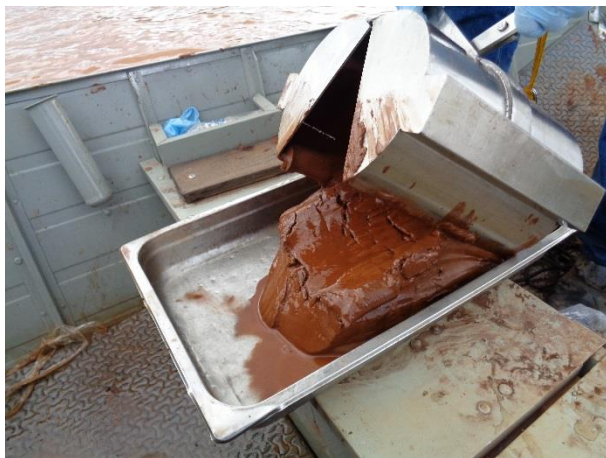
Figura 13: Transferência da amostra de sedimento de superfície para bandeja de inox.
