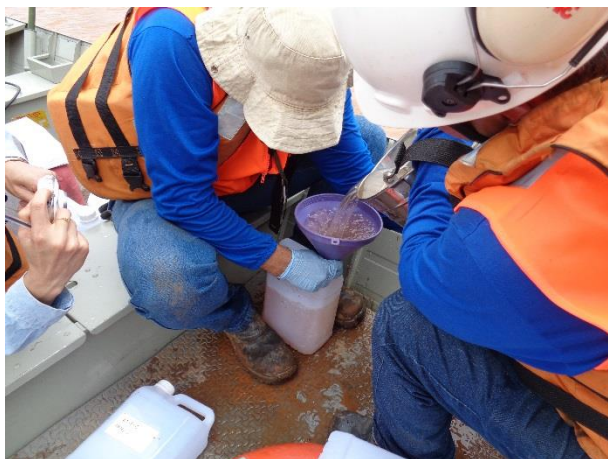
Figura 9: Enchimento dos recipientes com amostras de água bruta, coletadas em profundidade, para posterior filtração.
