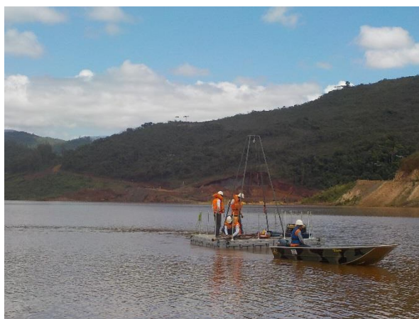
Figura 64: Vista panorâmica de equipamentos (balsa de sondagem e barco) utilizados na coleta de amostras de água e sedimento no Dique S3, Dique S4 e rio do Carmo (a imagem refere-se à coleta no reservatório do Dique S3).
