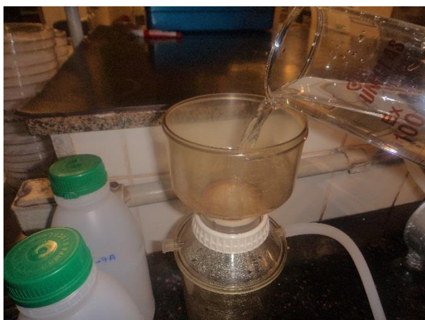
Figura 99: Filtração de amostra de água bruta com membrana filtrante de fibra de vidro.
