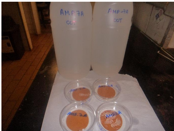
Figura 101: Conjunto de membranas de ésteres de celulose (0,45 \mu\text{m} ) e fracos contendo filtrados correspondentes (materiais de um mesmo ponto de amostragem).
