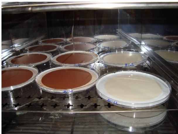
Figura 43: Panorama da disposição de membranas na estufa para posterior secagem.
