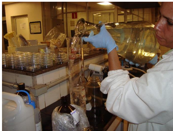
Figura 38: Transferência de amostra filtrada em 0,45 µm para determinação do volume a ser filtrado em 0,22 µm (membranas de fibra de vidro).
