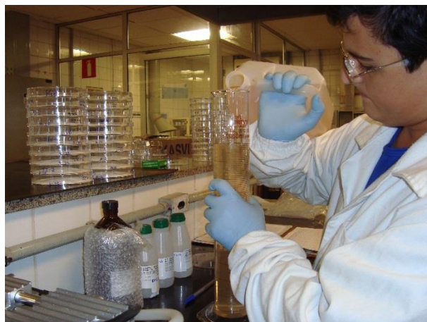
Figura 22: Transferência de amostra de água bruta para proveta, para determinação do volume a ser filtrado.
