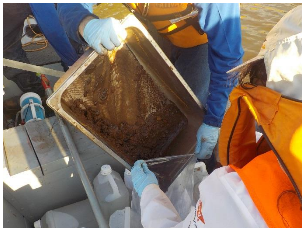
Figura 80: Transferência de amostra de sedimento de superfície de uma bandeja de inox para saco plástico.
