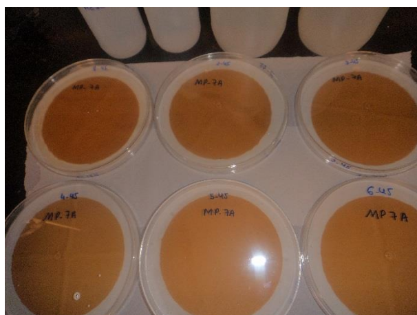
Figura 94: Membranas mistas de ésteres celulose de 0,45 µm após filtração, secagem e pesagem.
