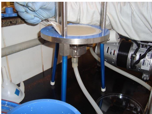
Figura 33: Retirada de membrana filtrante de 0,22 µm do suporte de filtro, após colmatagem da membrana.
