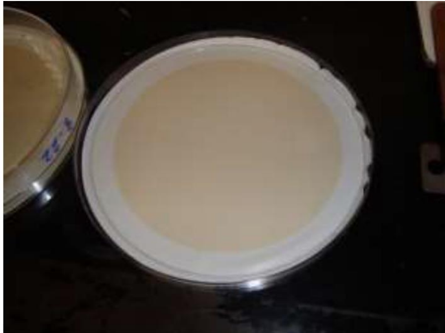
Figura 6. Exemplo de filtro 0,22 \mu\text{m} com material retido após filtração (a amostra filtrada nesta membrana já teria atravessado uma membrana 0,45 \mu\text{m} ).
