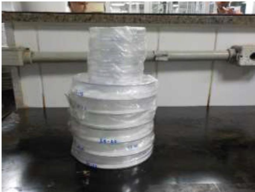
Figura 7. Exemplo de 2 conjuntos de placas de Petri com filtros 0,22 \mu\text{m} contendo materiais de uma mesma amostra. Conjunto superior: membranas de fibra de vidro. Conjunto inferior: membranas de nitrato de celulose
