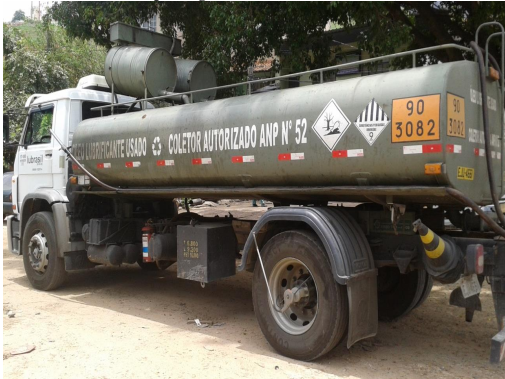
Figura 91: Caminhão tanque usado na coleta de óleo lubrificante usado – coletor autorizado pela Agência Nacional de Petróleo (ANP)
