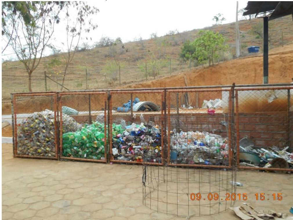
Figura 79: Baias para armazenamento temporário dos materiais recicláveis (plásticos e sucata) antes de serem enfardados
