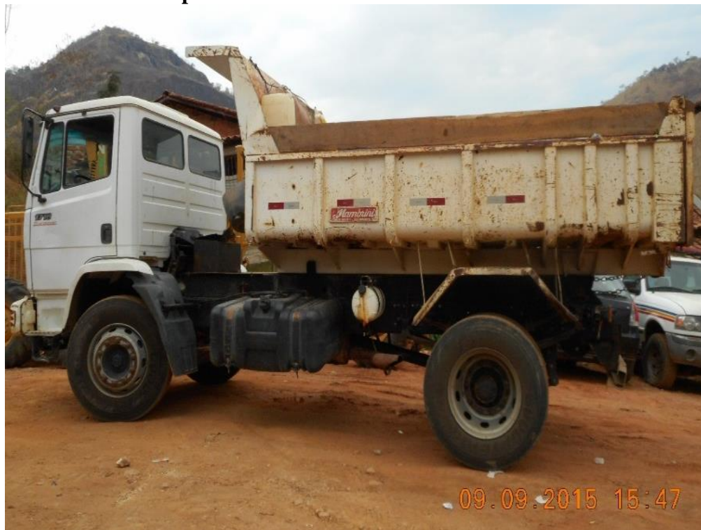
Figura 73: Caminhão com tábua fixada na lateral do basculante para ampliar a capacidade volumétrica de coleta de RSU
