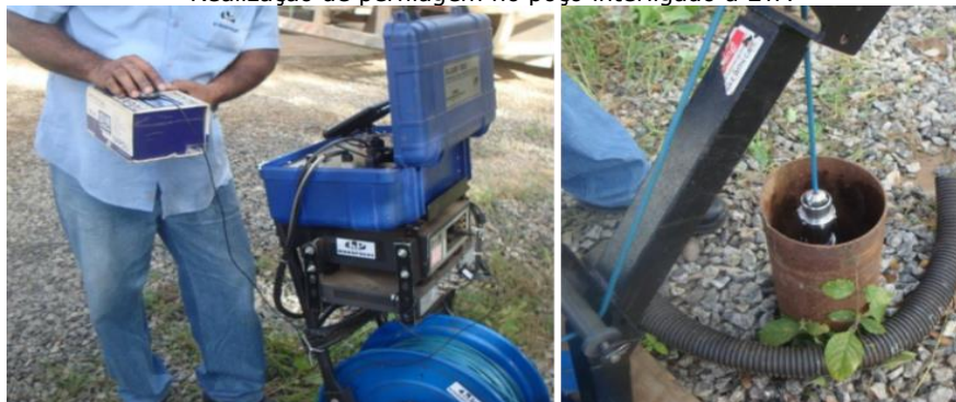
Realização de perfilagem no poço interligado à ETA
