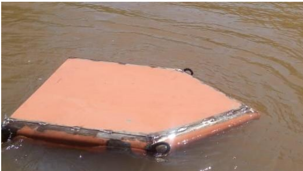
Foto 02: TESTE DE FLUTUAÇÃO E ESTABILIDADE LONGITUDINAL SEM OS CABOS DE FIXAÇÃO.
