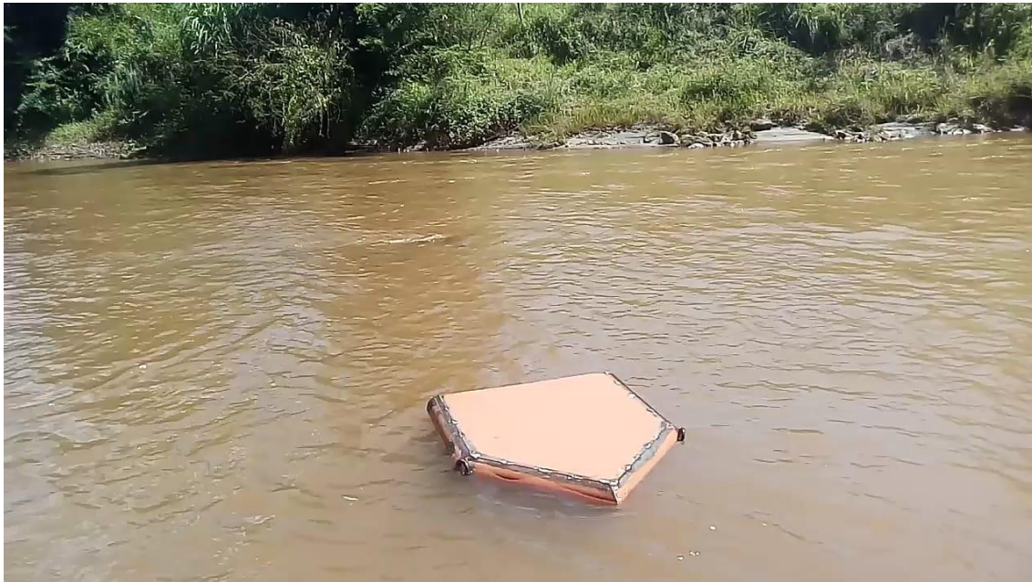
Foto 03: TESTE DE FLUTUAÇÃO EM CONDIÇÕES EQUIVALENTES AO QUE O EQUIPAMENTO SERÁ SUBMETIDO.
