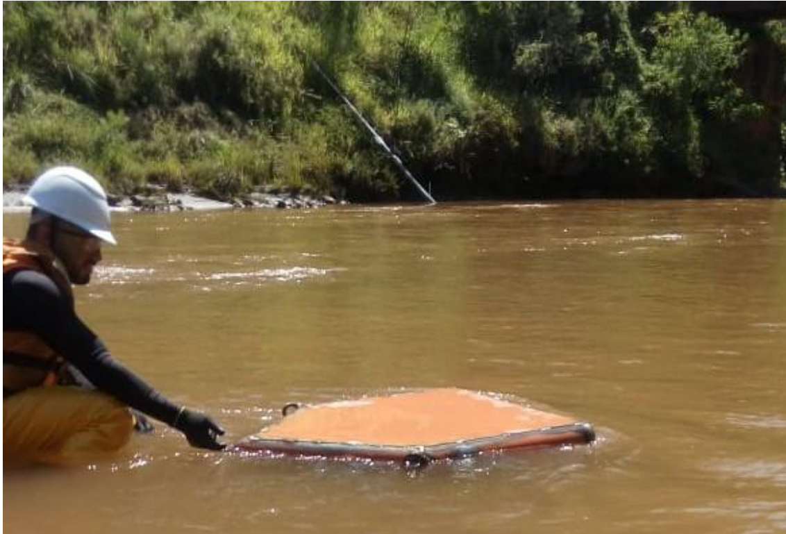
Foto 01: TESTE DE FLUTUAÇÃO E ESTABILIDADE LONGITUDINAL SEM OS CABOS DE FIXAÇÃO.
