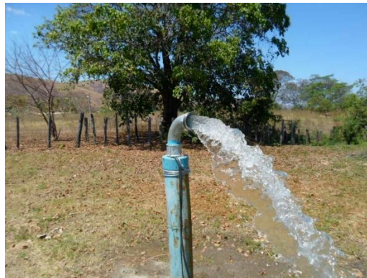
Poço 02 após limpeza, desinfecção e teste de bombeamento
