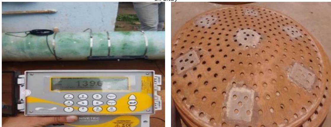
Figura 51 - Sistema de medição melhorado (à esquerda) e manutenção de anel de floculador (à direita)
