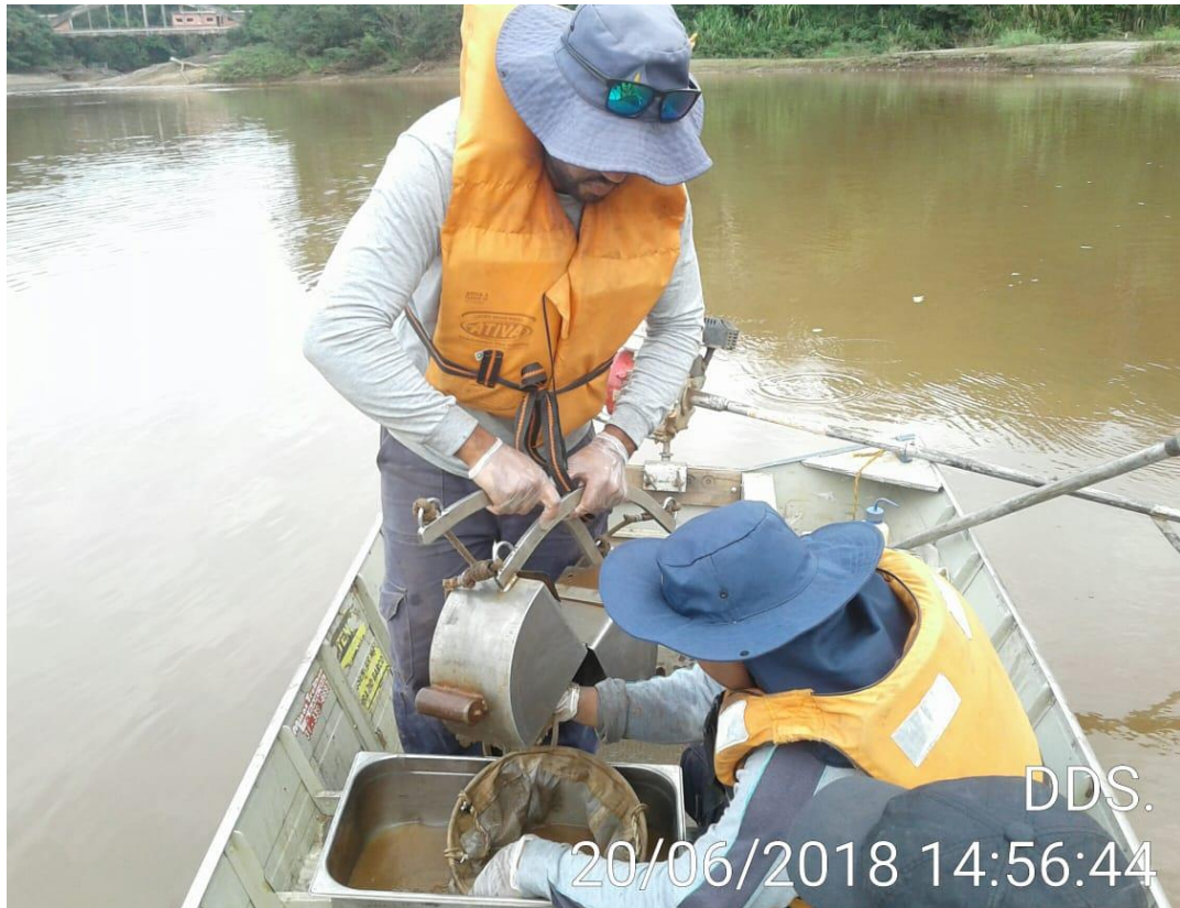
Figura 1 –Utilização da rede de 250µm para lavagem das amostras em campo.
