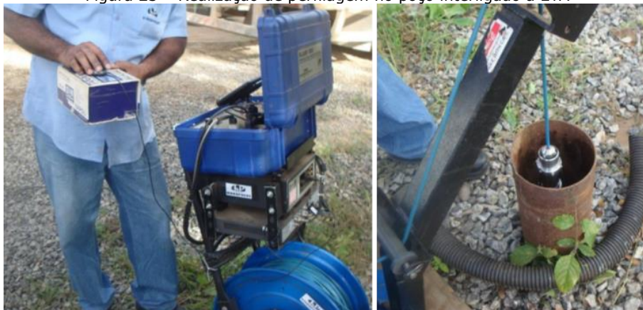
Figura 23 – Realização de perfilagem no poço interligado à ETA
