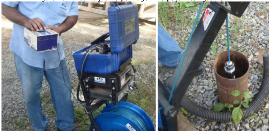
Figura 23 – Realização de perfilagem no poço interligado à ETA
