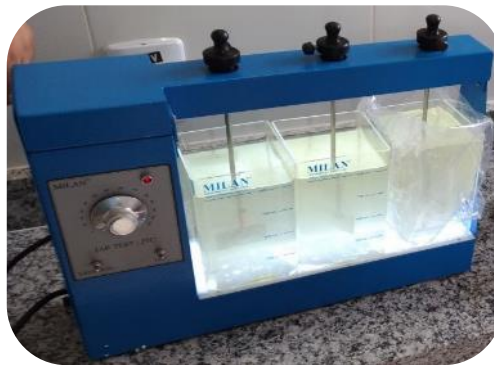
Figura 115 - Ensaio de tratabilidade realizado
