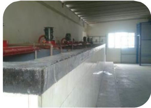
Figura 52: Melhoria dos tanques, que passaram por revestimento de fibra de vidro.
