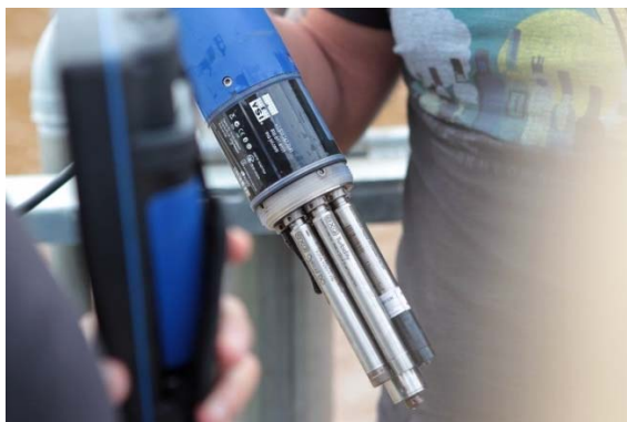
Figura 3.5: Sonda multiparamétrica para medição de qualidade de água nas estações Tipo II (Modelo EXO2 da YSI).
