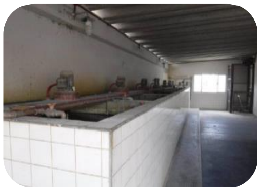
Figura 52: Melhoria dos tanques, que passaram por revestimento de fibra de vidro.
