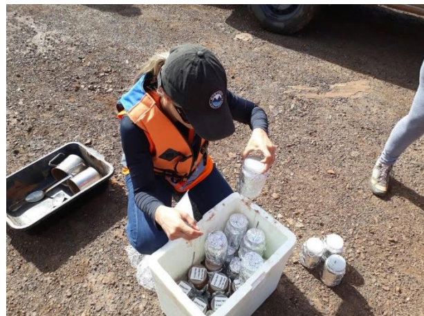
Acondicionamento dos frascos contendo o material inconsolidado coletado
