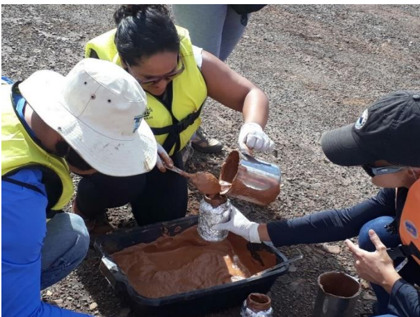
Transferência do material inconsolidado coletado para os recipientes após a homogeneização
