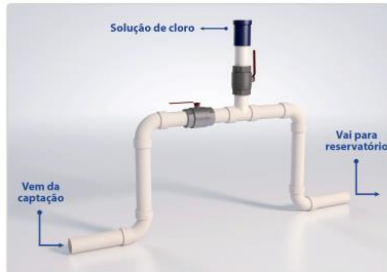
Figura 6: Esquema do Clorador Instalado na Tubulação
