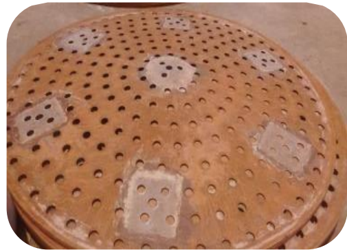
Figura 22: Sistema de medição melhorado (à esquerda) e manutenção de anel de floculador (à direita).
