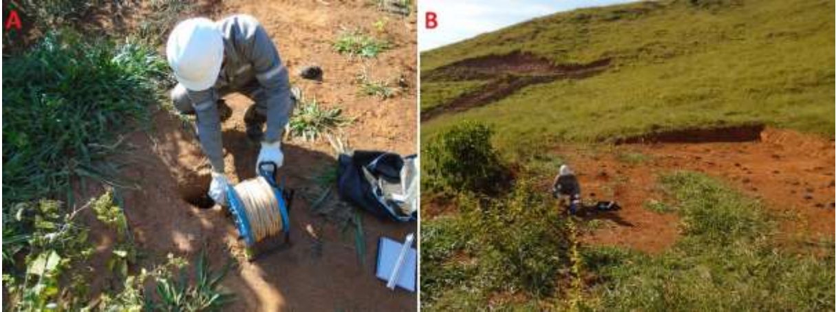
Foto 7.10: A) Processo de medição do nível d'água no ponto SCA-FS-01. B) Vista para a praça de sondagem onde está localizado o furo.
