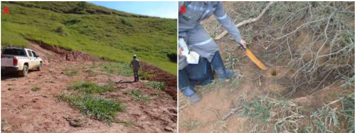
Foto 7.11: Pontos de controle das Pilhas I e II. A) Ponto SCA-PC-03 (Pilha I). B) Ponto SCA-PC-16 (Pilha II), furo de sondagem obstruído a partir de 4,0 m.
