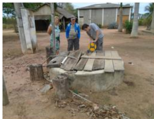
Leitura do N.A em Cisterna.
