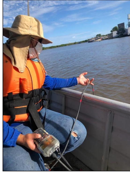
Figura 12. Medição de parâmetros físico-químicos da água "in situ" no ponto ERR 02R.
