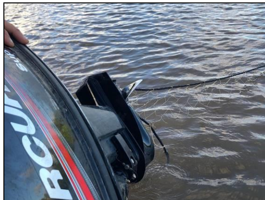
Figura 31. Rede enroscada na hélice do motor – ponto EBN 02R.
