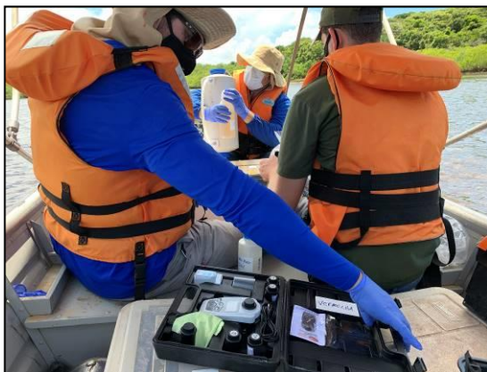
Figura 39. Medição de turbidez no ponto EIT 02 e envasamento de amostras de água.
