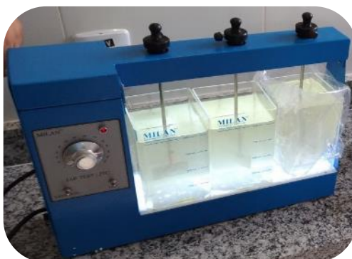
Figura 65: Ensaio de tratabilidade realizado
